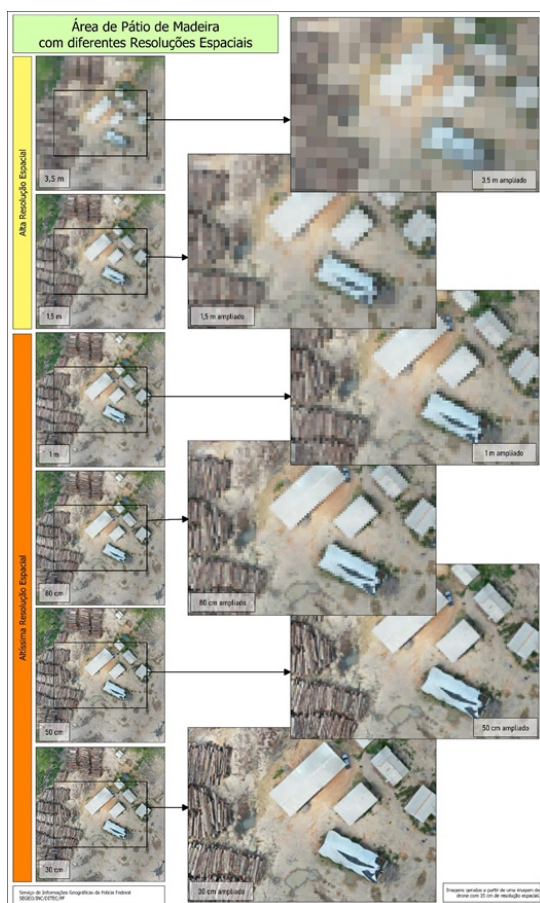
Figura 3. Pátio de madeira simulando diferentes resoluções espaciais. Fonte: SEGEO/INC/DITEC/PF.
